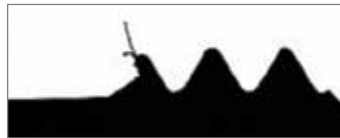
使用TECHSPEC® 1X银系列远心镜头和远心背光照明器所成的螺纹图像
