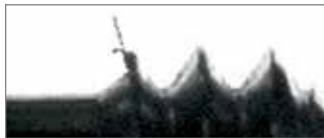
使用TECHSPEC® 1X银系列远心镜头和标准漫反射光源所成的螺纹图像
